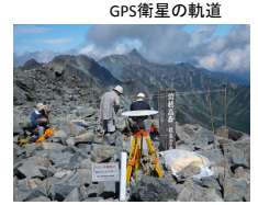
ハンディGNSS受信機 GPSを使った測量
